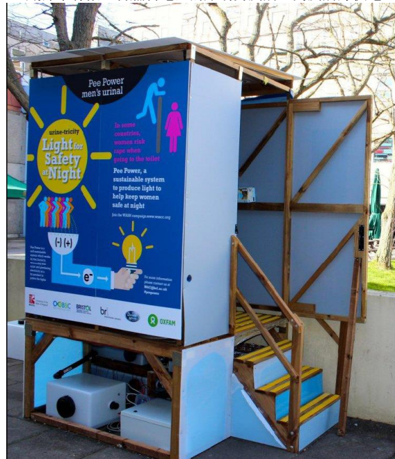
V1.底部带有微生物燃料电池的尿动力厕所。为厕所灯供电。
